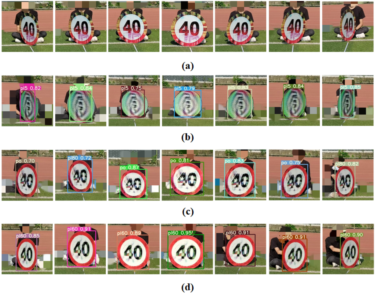
Fig. 14. Results of four attack vectors at varying angles ( -60^\circ, -45^\circ, -30^\circ, 0^\circ, 30^\circ, 45^\circ, 60^\circ ). (a) HA. (b) AA. (c) NTA. (d) TA.
